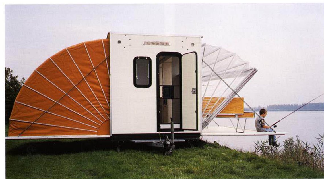
De Markies van Eduard Böhlingk, een ontwerp uit 1986 (prototype 1995). Uitklapbare caravan. Hier is het concept van de caravan gecombineerd met de techniek van markiezen tot een mobiele woning. Bij mooi weer kan je van je woonkamer een terras maken, door een simpele druk op de knop.
