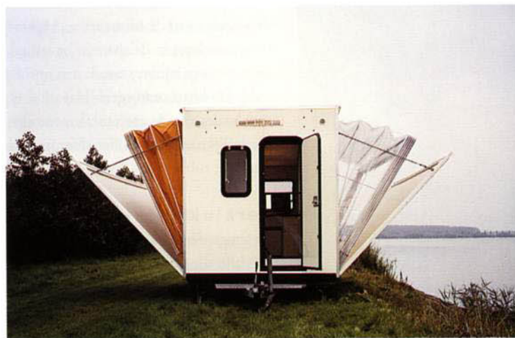
De Markies van Eduard Böhlingk, een ontwerp uit 1986 (prototype 1995). Uitklapbare caravan. Hier is het concept van de caravan gecombineerd met de techniek van markiezen tot een mobiele woning. Bij mooi weer kan je van je woonkamer een terras maken, door een simpele druk op de knop.
